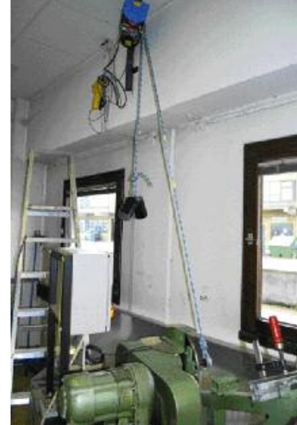
Der Edelrid-Stand im Detail: unten der Exzenter, oben der Stahlkarabiner mit zehn Kilo Gewicht am Seilende
