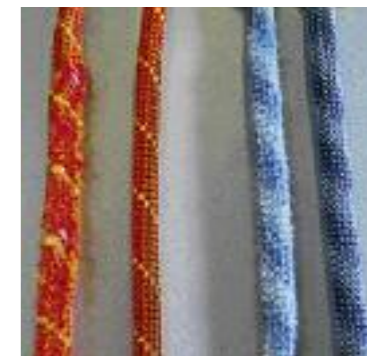
Aufreibend: die gleichen Seile mit dem Einsatz von Chalk (links) und ohne nach jeweils 150 Scheuerzyklen
