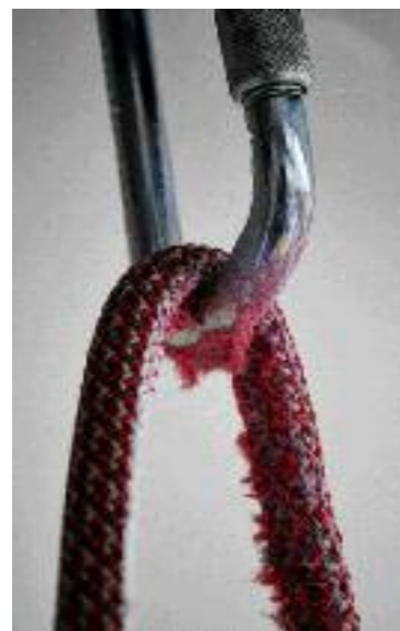
Scheuermann: Nur nach dem Zufügen von Chalk konnten wir den Seilen etwas »anhaben«.
