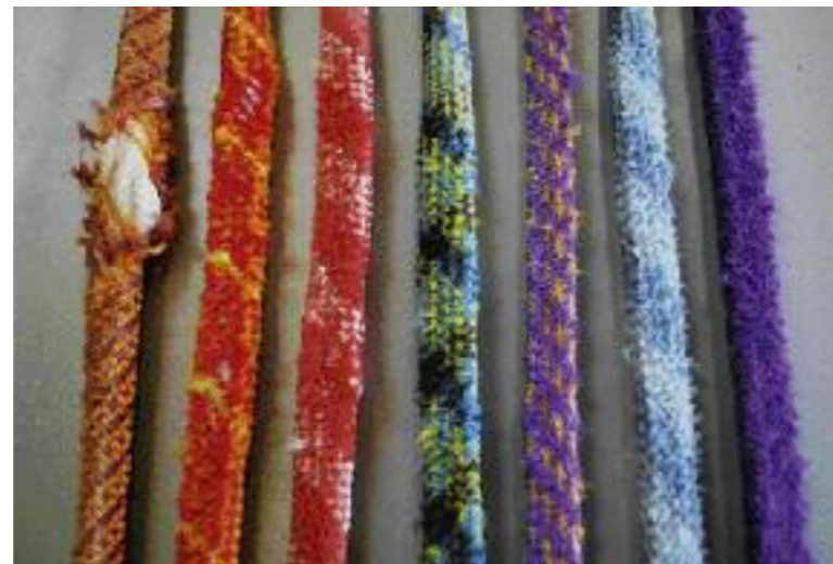
Erstaunlich: Alle Seile wiesen nach 150 Scheuerzyklen und dem Einsatz von Chalk deutliche Spuren auf.
